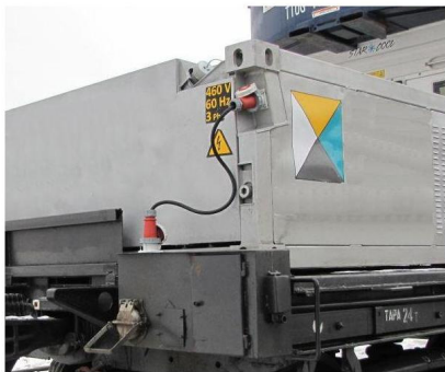
Рисунок 19 – Примеры подключения АДГУ к сети электроснабжения платформы а – подключение АДГУ «Прогрессор-01»; б – подключение АДГУ РКВ-15
